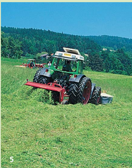
Unterschiedliche Mähetechnik im Fokus (4: Zweiachsmäher mit Doppelmesserbal-ken; 5: Kreiselmäher mit Aufbereiter).
